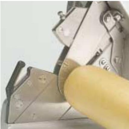
Mit der Abschneidvorrichtung kann der überschüssige Darm- oder Beutelzopf entfernt werden.
