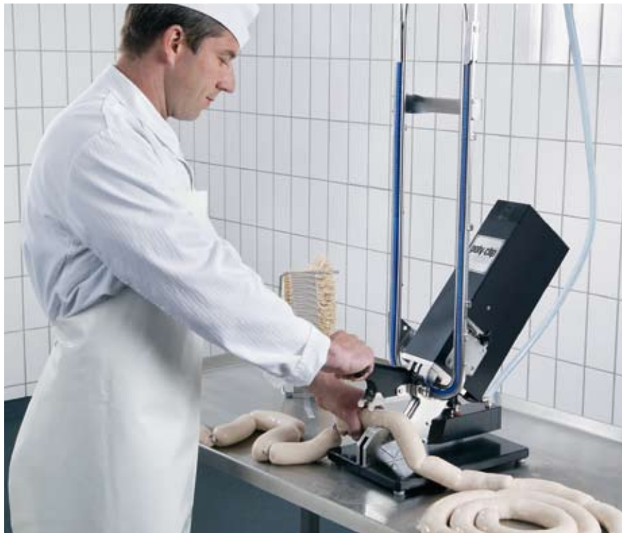
Die DCD 600 verschließt sicher alle Saitlinge, Schweine-, Rinderkranz- und Kunstdärme bis Kaliber 60 mm
