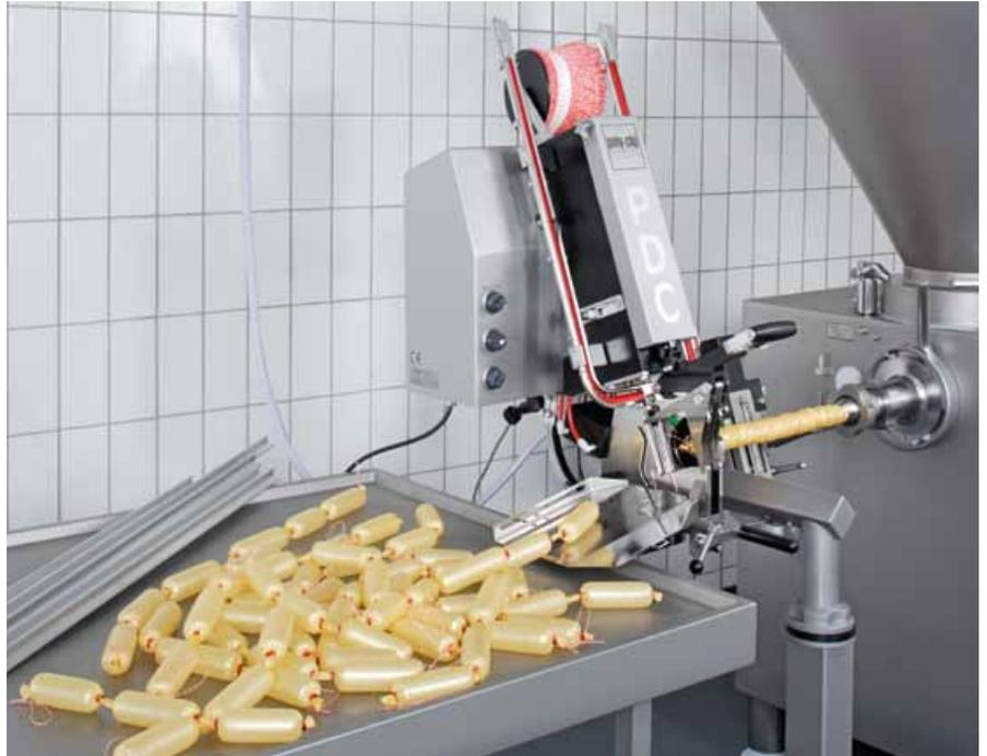
Produkte im Kaliberbereich bis 90 mm können mit der PDC 600 schnell und sicher hergestellt werden
